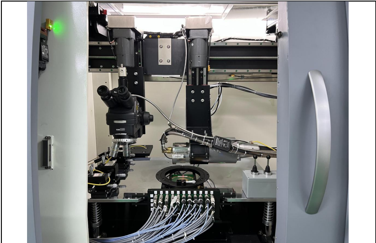
图 2-5 本项目晶片级器件辐照及辐射效应参数提取设备（MXR-165 型 X 射线机）
